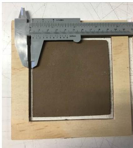
Figura 2. Muestra 2 para medición de retracción volumétrica (crédito: E. Ávila)
