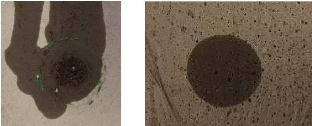
Figura 3. A la izquierda se observa el área de contacto de la probeta con la boca del tubo en la que el desgaste del material fue mínimo mientras que, a la derecha, en la cara opuesta de la muestra está la evidencia del flujo de agua sin deterioros (Crédito: L. Guerrero)
