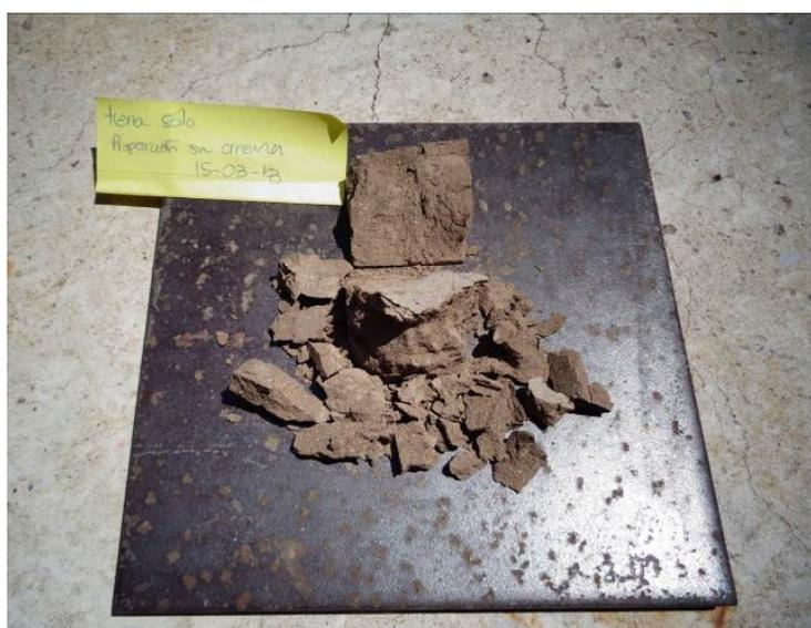
Figura 6. Las fracciones de una de las probetas correspondientes a la mezcla de tierra sólo con agua, evidencian una elevada densidad y consistencia. (Crédito: E. Ávila)
