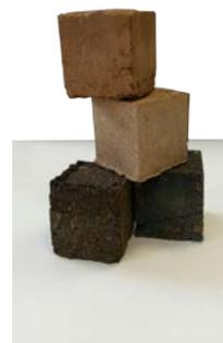
Figura 6. Probetas cúbicas de 40x40x40mm
