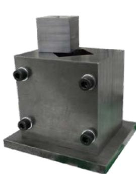
Figura 5. Molde para probetas cúbicas
