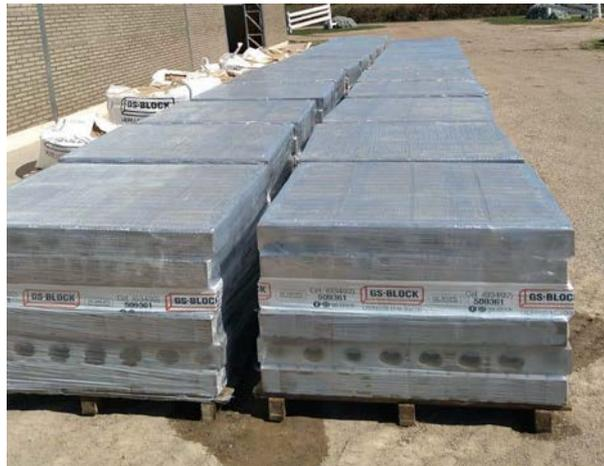
Figura 11: Paletizado y acopio final de los bloques
