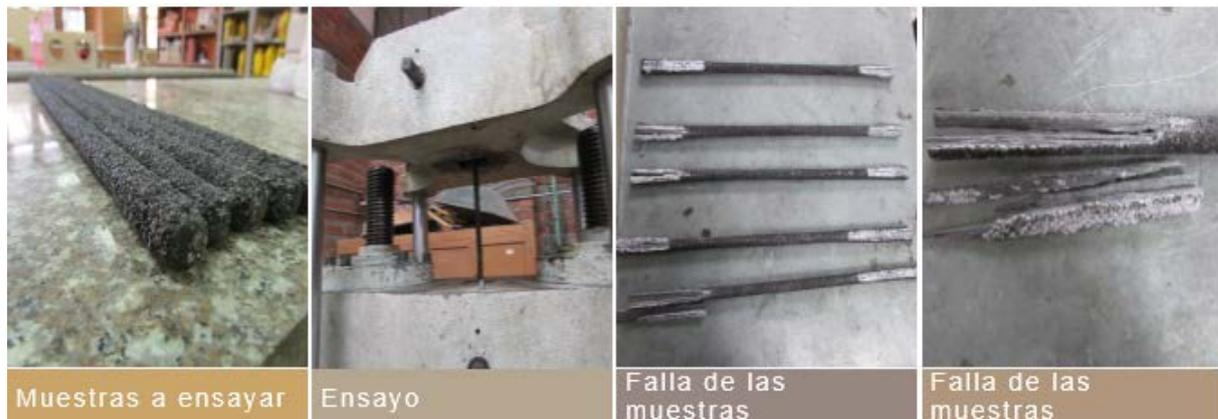
Figura 1. Ensayo a tracción de varillas de fibra de vidrio (Crédito: los autores)
