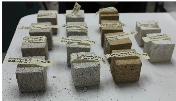
Figura 5. Probetas de ensayo de las distintas mezclas (acervo del LPSCT)
