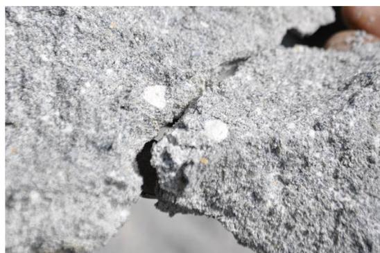
Figuras 2 y 3. Materiales de la tapia: a la izquierda, piedra pómez, tepojal, tezontle, barro renegrido al fondo; y a la derecha, residuo de cal (acervo del LPSCT)
