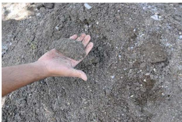
Figura 4. Materiales mezclados con el grado exacto de humedad (acervo del LPSCT)
