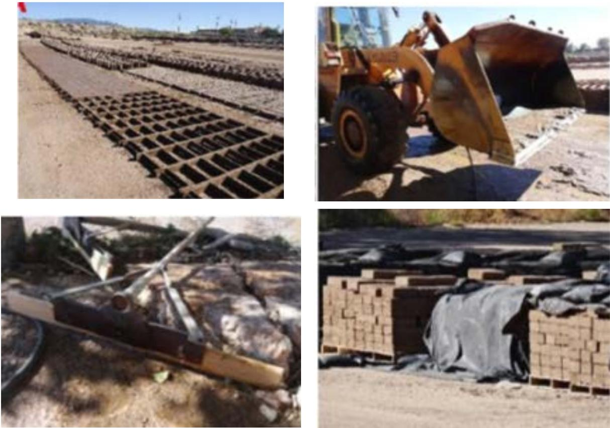
Figura 2. Linha A de produção semi-mecanizada
