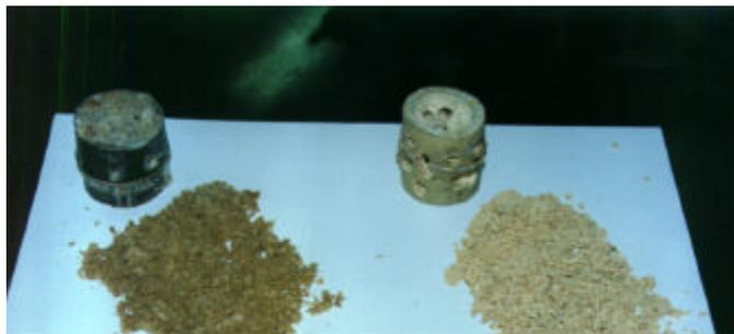
Foto 12: Control del contenido de humedad de las cañas.
