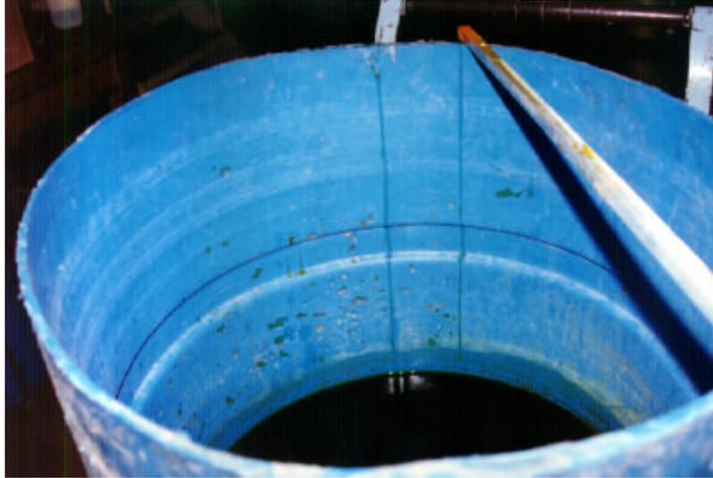
Foto 7: Solución de Conservación. Composición de cobre o cromo arsénico
