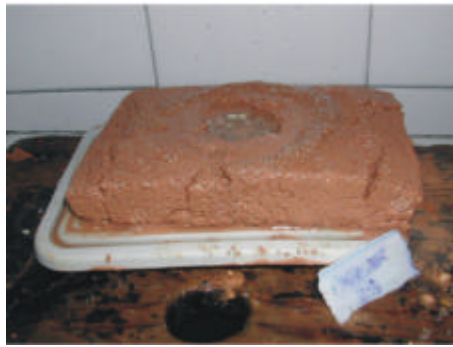
Fotografía nº 7 Medida del diámetro y profundidad del hueco producido
