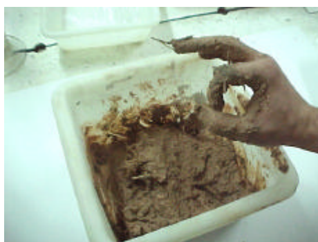
Fotografía nº2 Mezcla y homogeneización de la Tierra para la fabricación de probetas
