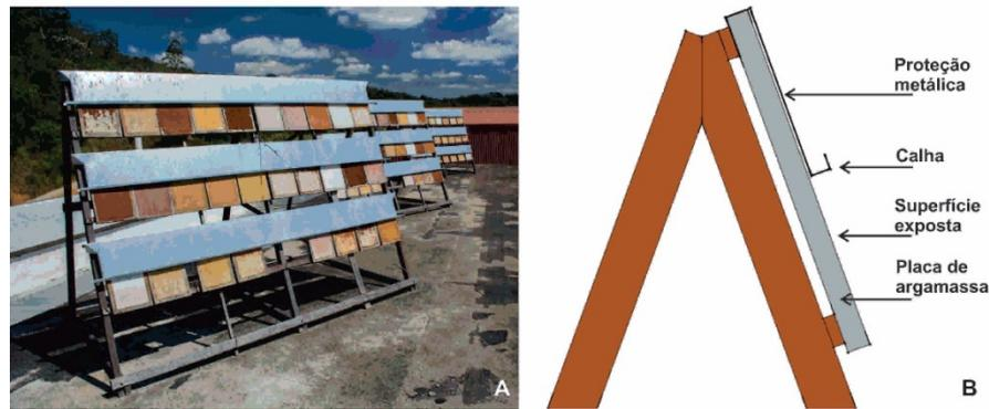
Figura 1 - Estruturas para realização do teste de resistência ao intemperismo natural: A) pinturas expostas ao intemperismo natural; B) detalhe do rack para fixação e exposição das placas de argamassa ao intemperismo natural
