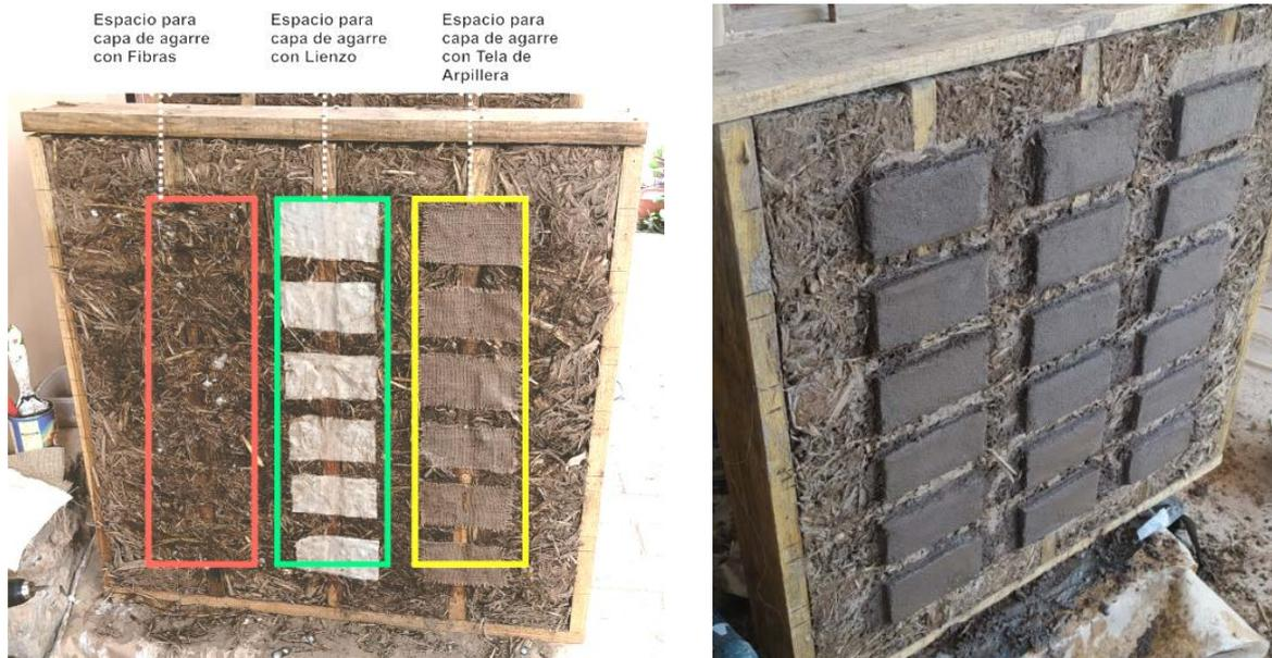
Figura 2. Capas de agarre y revocos por panel
