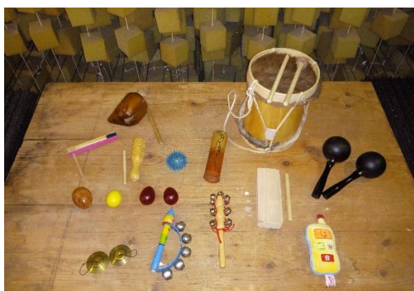
Fotografías 1 a 4: Caracterización sonora de objetos en cámara anecoica
