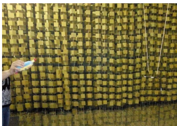
Fotografías 1 a 4: Caracterización sonora de objetos en cámara anecoica
