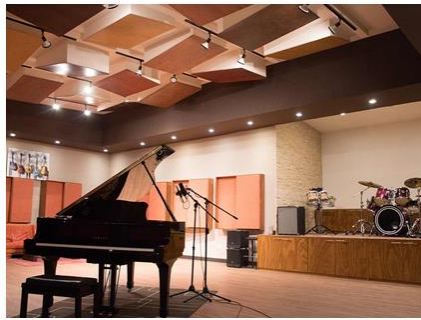
Figuras 2 y 3. Ejemplos de diseños adaptables. En la figura 2 estudio de grabación con paneles móviles con diferentes materiales de cada lado para poder modificar el tiempo de reverberación según el tipo sonido a grabar. En la figura 3 un sistema de audio para poder mejorar el sonido en auditorios [4] [5]
