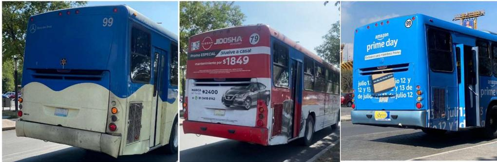
Figura 16. Fotografías de parte trasera de camiones, donde se puede observar la parrilla de entrada de aire al motor
