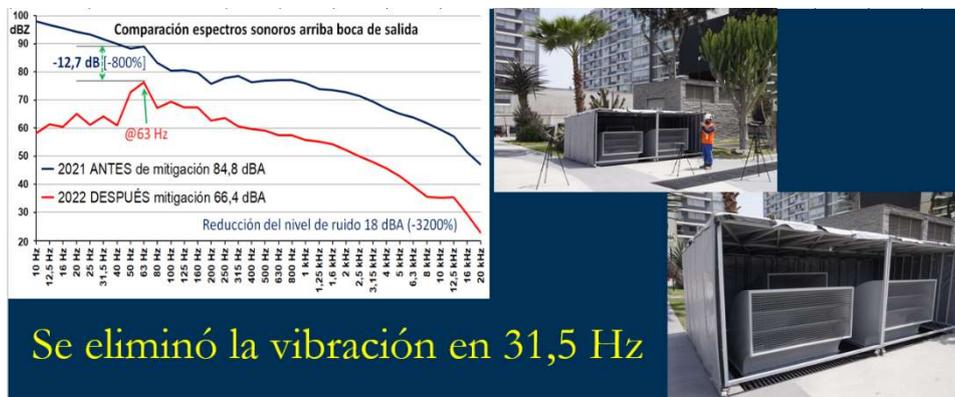
Figura 6: Análisis de las mediciones después de colocar silenciadores
