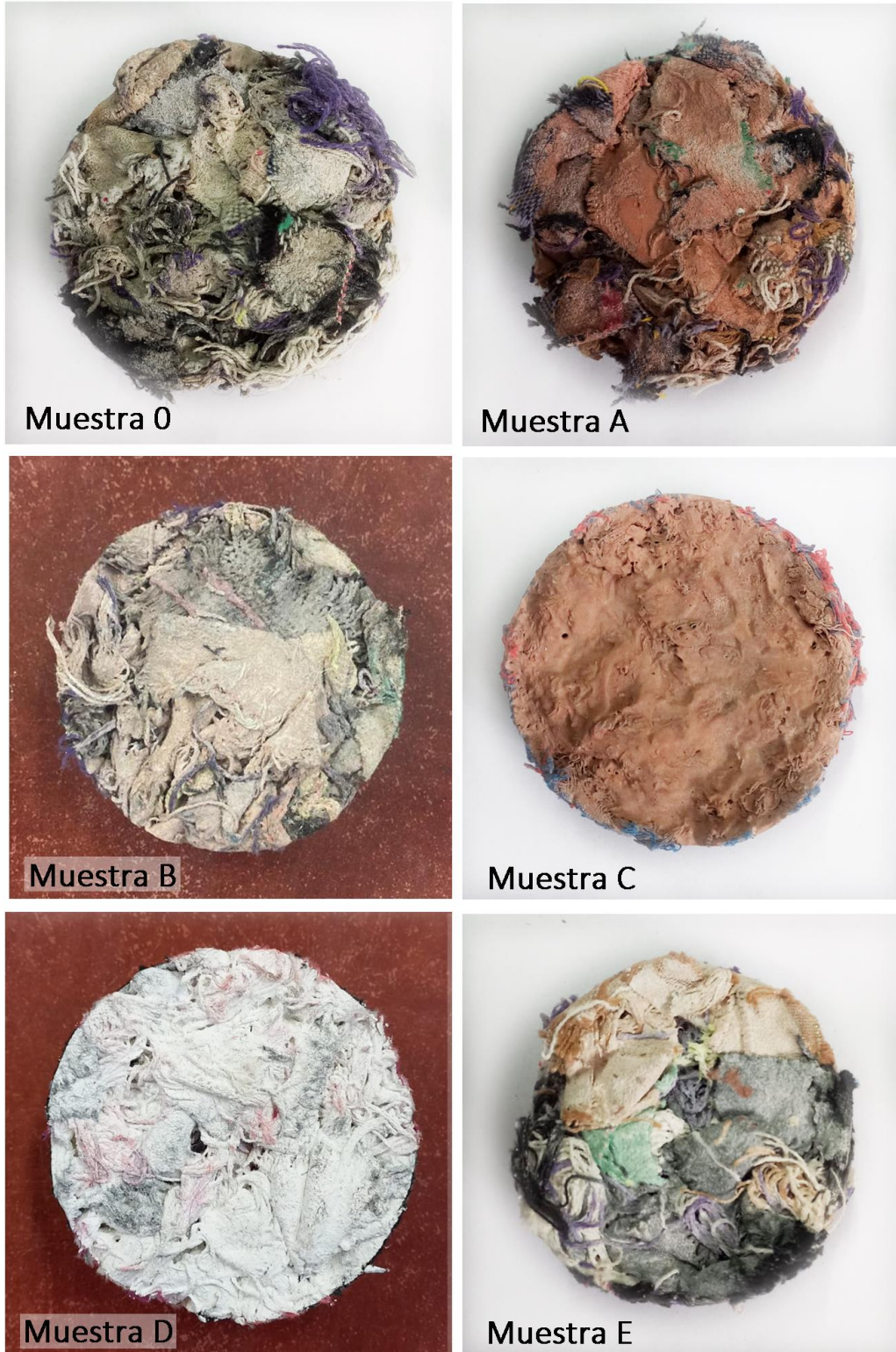
Figura 6. Muestras para mediciones en Tubo de Impedancia. Variantes de la muestra Texacem®.
