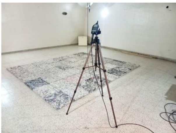
Figura 3. Montaje de placas para el ensayo en cámara reverberante
