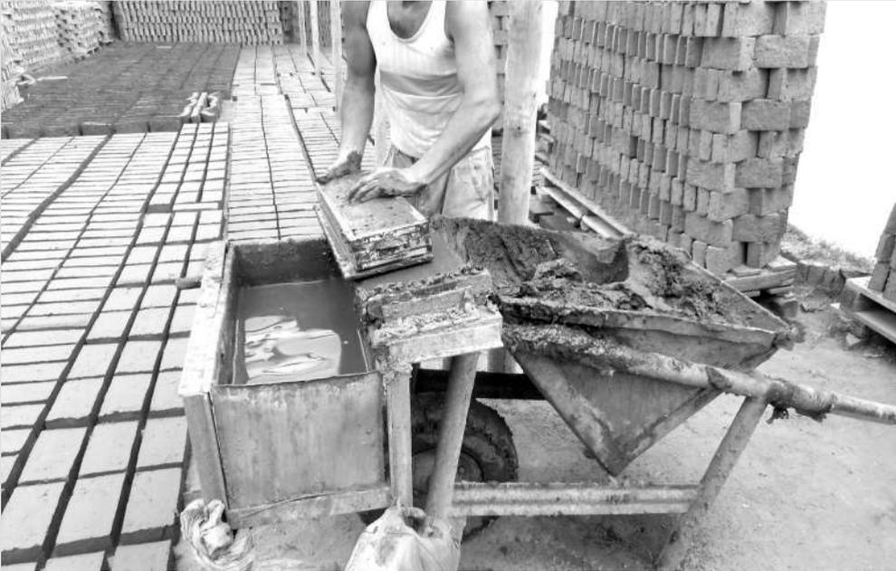
**GRÁFICO 3.** LADRILLERO ENRASANDO LOS MOLDES PARA VOLCARLOS EN LA "CANCHA". FÁBRICA ARTESANAL DE LADRILLOS CAMELOT, MONTEVIDEO
