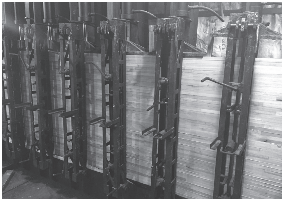
FIGURA 6. PRENSADO DE VMLE. FUENTE: ELABORACIÓN PROPIA.
