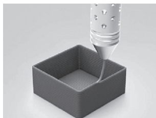
FIGURA 2. ILUSTRACIÓN DEL PROCESO DE IMPRESIÓN POR DEPOSICIÓN DE FILAMENTO. FUENTE: LAS 4 TECNOLOGÍAS DE IMPRESIÓN 3D MÁS POPULARES DEL MERCADO DE ROBIN PÉREZ, 2015, HTTP://TECNOIMPRE3D.COM/4-TECNOLOGIAS/
