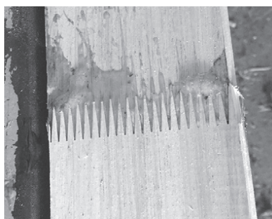
FIGURA 5. UNIÓN DENTADA LUEGO DEL PRENSADO. FUENTE: ELABORACIÓN PROPIA.
