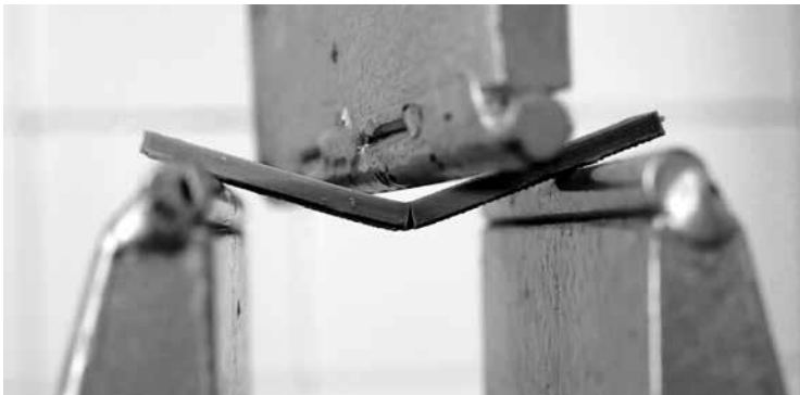
FIGURA 11. MODELOS IMPRESOS, SOMETIDOS A ESFUERZOS DURANTE LOS ENSAYOS. FUENTE: ELABORACIÓN PROPIA.
