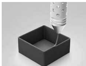
FIGURA 2. ILUSTRACIÓN DEL PROCESO DE IMPRESIÓN POR DEPOSICIÓN DE FILAMENTO. FUENTE: LAS 4 TECNOLOGÍAS DE IMPRESIÓN 3D MÁS POPULARES DEL MERCADO DE ROBIN PÉREZ, 2015, HTTP://TECNOIMPRES3D.COM/4-TECNOLOGIAS/
