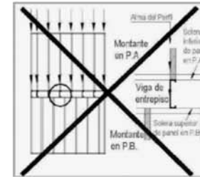
FIGURA 6. INCORRECTA RESOLUCIÓN DE LA TRANSMISIÓN DE CARGAS. FALTA DE ALINEACIÓN DE LOS ELEMENTOS ESTRUCTURALES. FUENTE: MANUAL DE PROCEDIMIENTO (2015, P.59)
