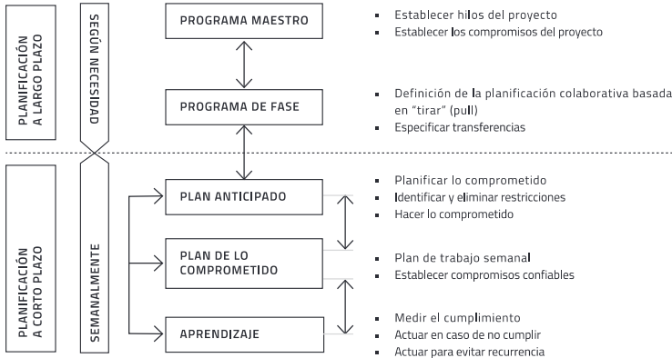
FIGURA 3. ETAPAS DE LA PLANIFICACIÓN DE LA PRODUCCIÓN DE ACUERDO CON EL LASTPLANNERSYSTEM. FUENTE: GRÁFICO DE BALLARD ET AL. (2012) ADAPTADO POR HEIGERMOSER ET AL. (2019), HTTPS://DOI.ORG/10.1080/21573727.2011.641117
