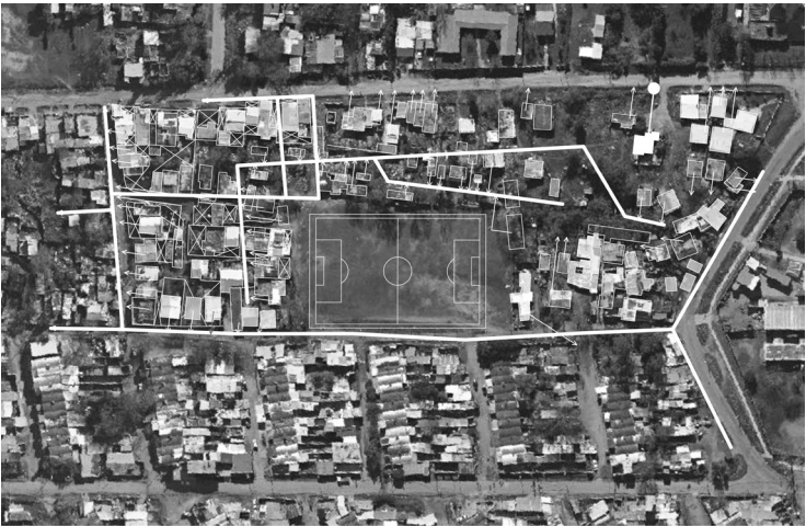
FIGURA 2. EJEMPLO DE DATOS RELEVADOS VOLCADOS AL PLANO DE LA Z1. TRAZO BLANCO: CURSOS DE AGUA PRESENTES. FLECHAS BLANCAS: DESAGÜE PRIMARIO DE VIVIENDAS A CIELO ABIERTO; GRIS: SOLO SECUNDARIA; BLANCA CON PUNTA CIRCULAR: A COLECTOR
