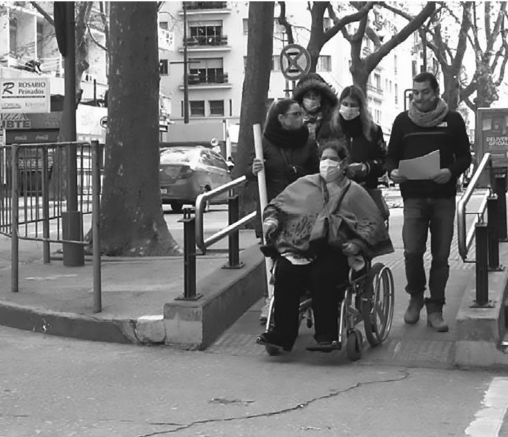
FIGURA 4. PRUEBAS DEL SOFTWARE KOBO TOOLBOX EN LAS INMEDIACIONES DE LA INTENDENCIA, ANTE LA CARENCIA DE RECURSOS PARA COMPRAR CINTAS MÉTRICAS SE USARON CAÑOS DE PVC DE 120 CM PARA VERIFICAR ANCHOS DE PASO, ESO LUEGO EVITÓ ERRORES DE MEDICIÓN. FOTOGRAFÍA DE GERMÁN GIL
