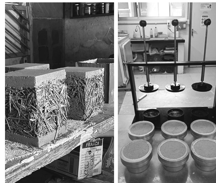
FIGURA 5. (A) MUESTRA COMPUESTA —BARRO Y PAJA— PARA ENSAYO DE CONDUCTIVIDAD TÉRMICA, (B) PREPARACIÓN DE MUESTRAS PARA ENSAYO DE PERMEABILIDAD AL VAPOR DE AGUA
