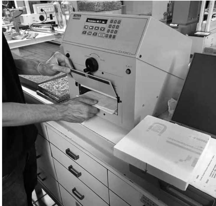
FIGURA 6. ENSAYO DE CONDUCTIVIDAD TÉRMICA. FUENTE: FOTOGRAFÍA DEL EQUIPO DE AUTORES
