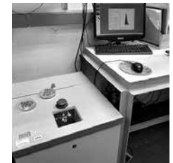
FIGURA 4 Y 5. ENSAYO DE DIÁMETRO MEDIO DE FIBRA. FUENTE: FOTOGRAFÍAS DEL EQUIPO DE AUTORES
