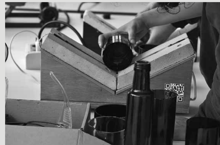
FIGURA 5. TALLER PARA VASOS BOTELLAS EN TERRAZA DE AMPLIACIÓN FADU. SE MUESTRA UN MODELO DE HERRAMIENTA DE CHOQUE TÉRMICO SELECCIONADO PARA LOS TALLERES EN TERRITORIO. FUENTE: ESPACIO DE FORMACIÓN INTEGRAL PRÁCTICAS SUSTENTABLES DE DISEÑO EN VIDRIO- LABORATORIO DE VIDRIO. AUTOR: GASTÓN ADINOLFI
